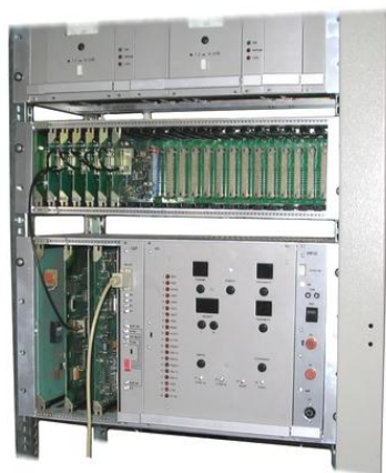
Рисунок 4.4 – Каркас ОЛПУ с каркасом ОК и ОЛПУ-М с каркасом ОК-М
