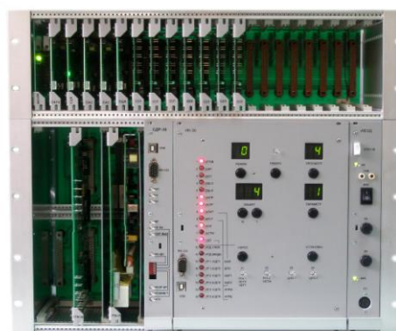
Рисунок 4.4 – Каркас ОЛПУ с каркасом ОК и ОЛПУ-М с каркасом ОК-М
